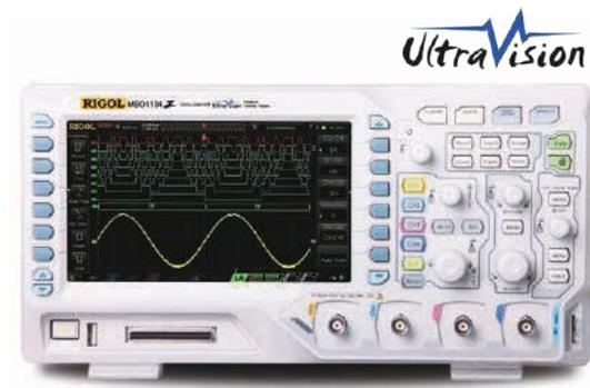
Серия DS1000Z — это высокопроизводительные экономичные осциллографы общего назначения с 4 аналоговыми каналами, полосой пропускания от 50 до 200 МГц и частотой дискретизации до 1 Гвыб/с. Благодаря технологии UltraVision серия DS1000Z сохранила свои характеристики большого объема памяти и высокой скорости захвата.
