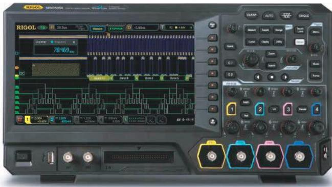
В цифровом осциллографе Rigol серии MSO5000 используется разработка компании Rigol - процессор "Phoenix", что обеспечивает частоту дискретизации в реальном времени до 8 Гвыб/с, а технология UltraVision 2 позволяет увеличить размер глубины записи до 200 М точек, скорость захвата осциллограмм до 500 000 осц/с.
