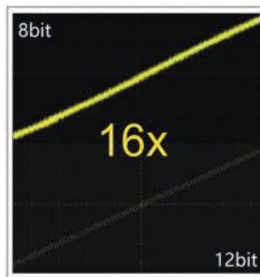
Высокое вертикальное разрешение в 12 бит в сочетании с рекордно низким собственным шумом осциллографа позволяет увидеть даже мельчайшие детали в сигнале.
