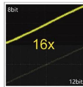
Осциллограф экономического класса с разрешением 12 бит по вертикали – лучшее решение для начинающих разработчиков.
