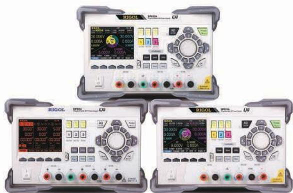
Серия DP800 - это высокопроизводительный программируемый линейный источник питания постоянного тока. Все модели обладают превосходными характеристиками, включая выходы с синхронизацией, низкий уровень пульсаций и шума, комплексную защиту от перегрузки по напряжению, току и температуре.
