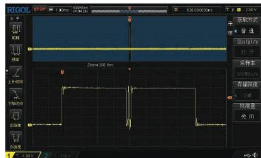
Обеспечивает захват длительных сигналов с большим разрешением
