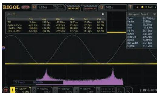
Измерение TIE для тактового сигнала с джиттером и анализ результатов измерения с помощью графика тренда и тстограммы
