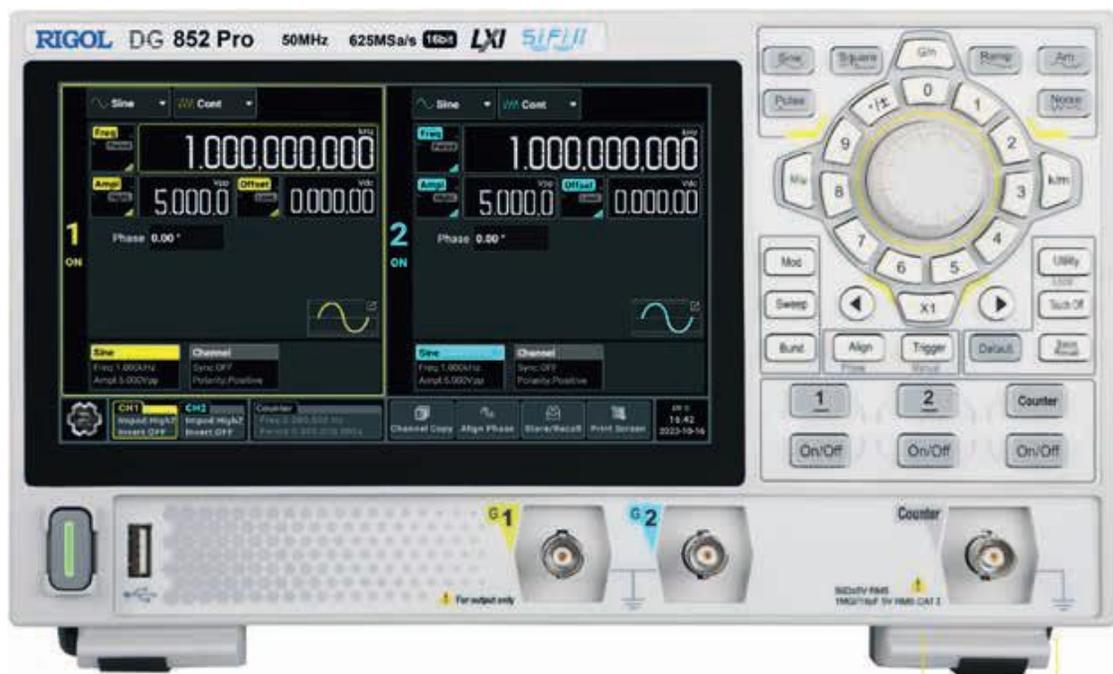
Серия генераторов сигналов произвольной формы DG800 Pro имеет частоту дискретизации до 625 Мвыб/сек и глубину памяти 2 Мвыб на каждый канал в базовой комплектации. Это бюджетное и эффективное решение, объединяющее в себе множество различных функций, таких как функциональный генератор, генератор сигналов произвольной формы, генератор шума, импульсный генератор, генератор гармоник, возможности аналоговой/цифровой модуляции и частотомер.
