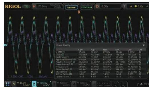
Осциллографы серий DS8000-R, MSO8000, MSO/DS7000, MSO5000 и MHO/DHO5000 поддерживают дополнительное встроенное программное обеспечение, которое может выполнять анализ качества электропитания и анализ пульсаций. Программное обеспечение призвано помочь инженерам быстро и точно проанализировать часто используемые параметры мощности без необходимости выполнять утомительную настройку вручную или выполнять сложные расчеты.
