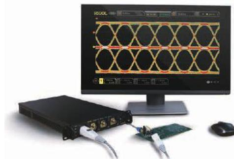
Интерфейс HDMI позволяет осуществить подключение к внешнему дисплею
