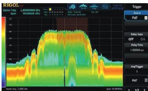
Запуск по частотной маске FMT — это уникальный режим запуска для анализаторов спектра в реальном времени. Вы можете быстро создать шаблон и захватить сигнал, соответствующий шаблону частотной маски
