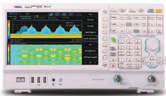
Серия содержит 4 модели: RSA3015E, RSA3015E-TG, RSA3030E, RSA3030E-TG. В модели с TG включен следящий генератор. Частотный диапазон: 9 кГц до 1.5 ГГц; 9 кГц до 3 ГГц. Благодаря технологии Ultra Real анализатор обеспечивает четыре режима (GPSA, RTSA, EMI, VSA) работы. Режим свипирующего анализатора может пропустить сигнал из-за мертвого времени и медленной развертки. Анализатор спектра реального времени может идеально решить эту проблему.
