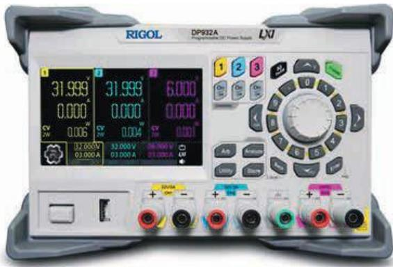
Для расширения диапазонов тока и напряжения можно внутренне объединять 1-ый и 2-ой каналы параллельно или последовательно. Больше никаких проблем с кабелями и сборками, т.к. они для этого не требуются. DP932A поставляется со всеми возможностями, а DP932U имеет дополнительное улучшенное разрешение, цифровые входы/выходы и улучшенную скорость изменения выходного сигнала. DP932U также имеет безопасные штекеры вместо соединительных штифтов.
