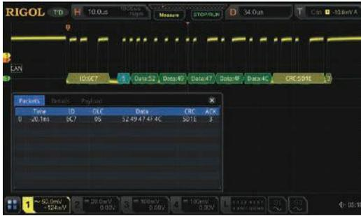
Анализ 4-х шин последовательных данных одновременно
