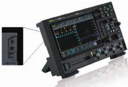
Интерфейс Type-C обеспечивает питание осциллографа как от сети, так и от портативных аккумуляторов, делая тестирование устройств более удобным.
